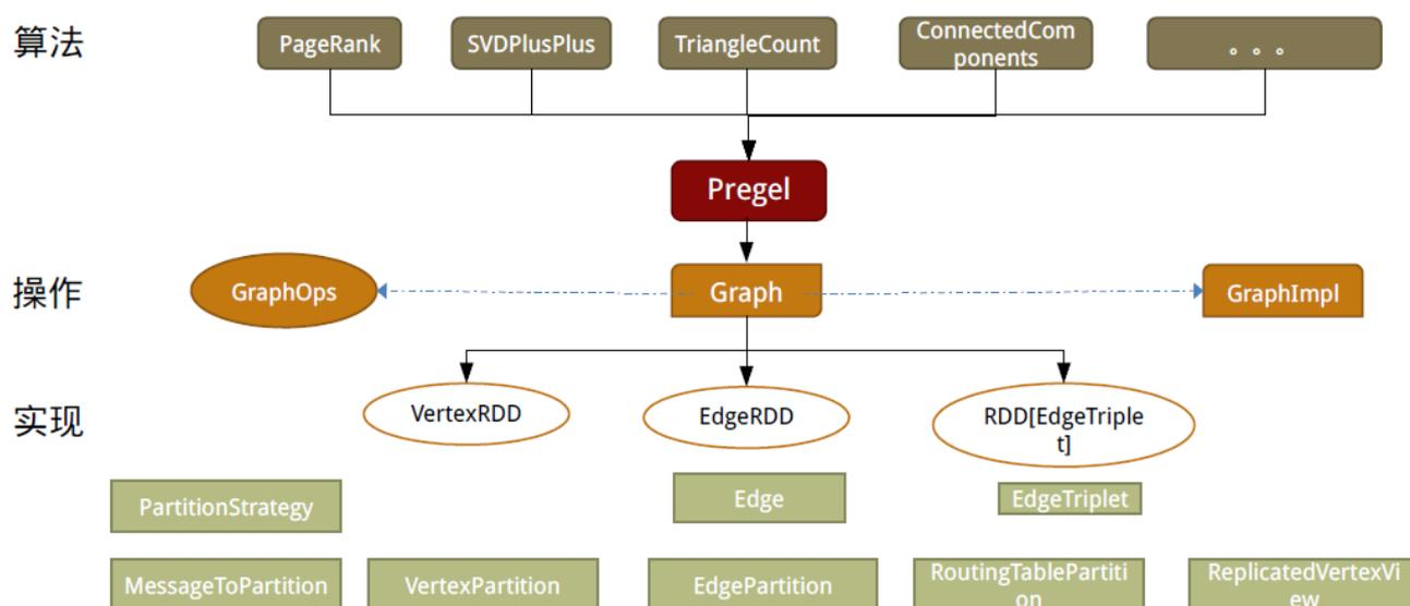
如同 Spark，GraphX 的代码非常简洁。GraphX 的核心代码只有 3 千多行，而在此之上实现的 Pregel 模式，只要短短的 20 多行。GraphX 的代码结构整体如下图所示，其中大部分的实现，都是围绕 Partition 的优化进行的。这在某种程度上说明了点分割的存储和相应的计算优化，的确是图计算框架的重点和难点。
