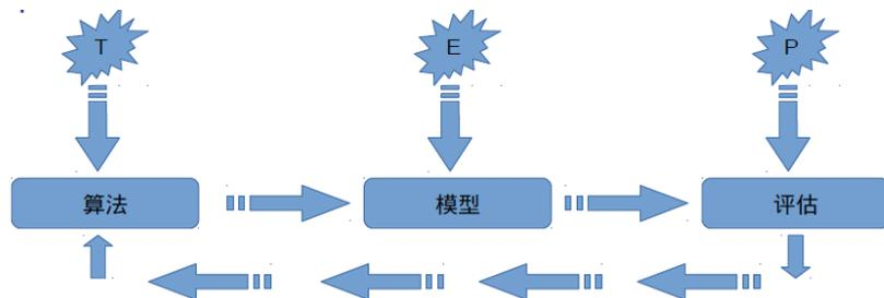
上图表明机器学习是数据通过算法构建出模型并对模型进行评估，评估的性能如果达到要求就拿这个模型来测试其他的数据，如果达不到要求就要调整算法来重新建立模型，再次进行评估，如此循环往复，最终获得满意的经验来处理其他的数据。
