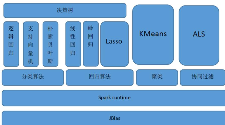
MLlib 基于 RDD, 天生就可以与 Spark SQL、GraphX、Spark Streaming 无缝集成, 以 RDD 为基石, 4 个子框架可联手构建大数据计算中心！
