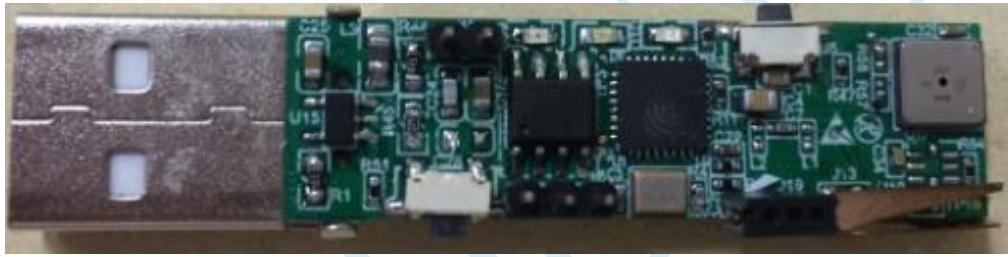
图 5: 基于 ESP8266 的传感器应用硬件示意图
