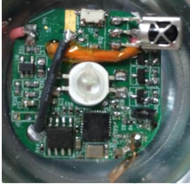
图 6：基于 ESP8266 的智能灯应用硬件示意图
